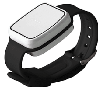
Funk-Notrufknopf mit Fall-/Sturzdetektor (tragbar als Halskordel oder als Armband)
